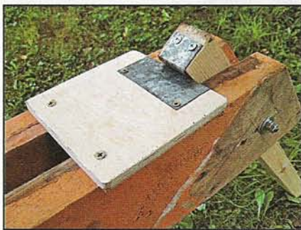
Металлические накладки на задней ножке и упоре может быть и не нужны, но запас прочности не повредит.
