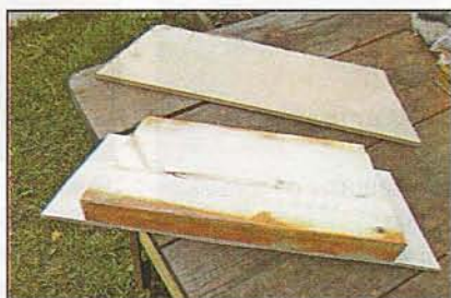
Фанерные накладки усиливают перемычку козел.
