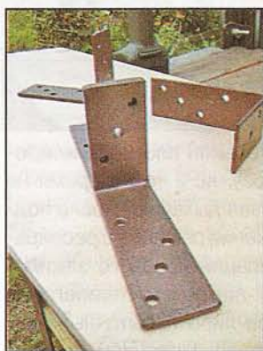
Центральное отверстие в уголках служит для их надёжного соединения шпилькой.
